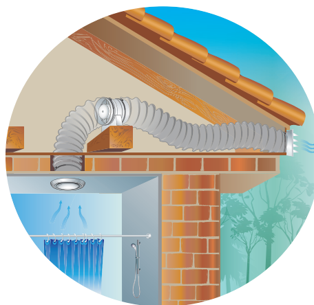
VKOk fan cottage ventilation example
